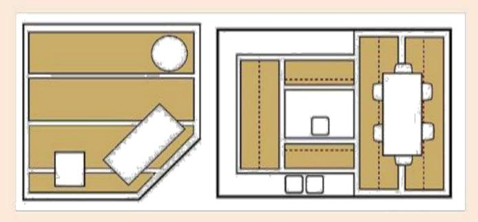
Сплошной карбоновый слой у *Термоплёнки «Russian Heat» HP APN-410* позволяет делать линии отреза произвольно и исключает образования холодных зон. Это очень удобно при монтаже в помещениях со сложной конфигурацией, а также позволяет обойти мебель любой формы.
